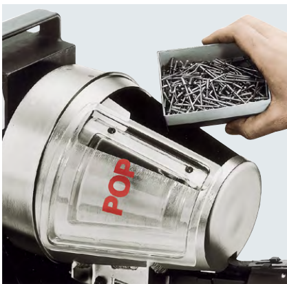
Behälter mit ca. 1000 Blindniete füllen (siehe Füllmarke)
