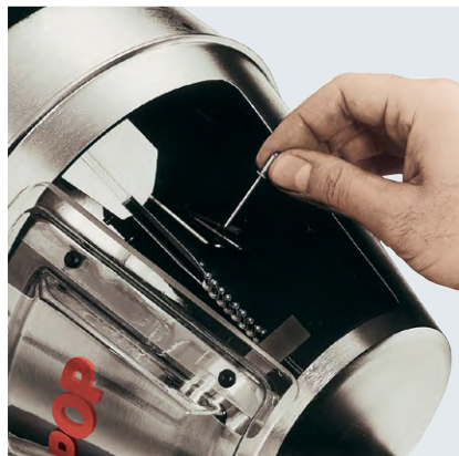
6 - 8 Blindniete von Hand in die Gleitschiene des Präsentiers legen
